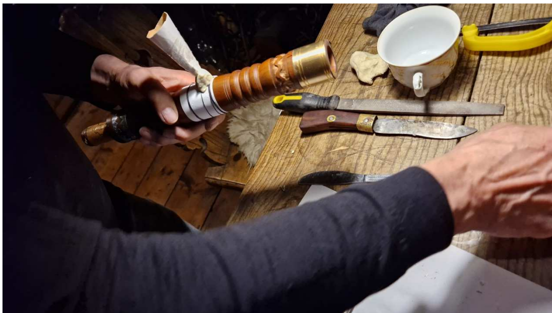
Zdjęcie nr 13 – Przygotowanie papierowego stożka do oblewania (materiały własne).
