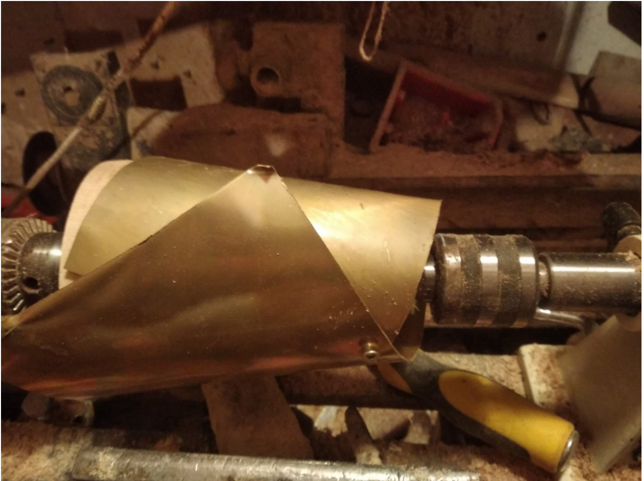
Ilustracja 11: Jedna z metod dopasowania blachy mosiężnej - nawinięcie na „kopyto”.
