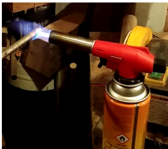
Ilustracja 17: Odpuszczanie można wykonać prostym palnikiem na kartusze gazowe.
