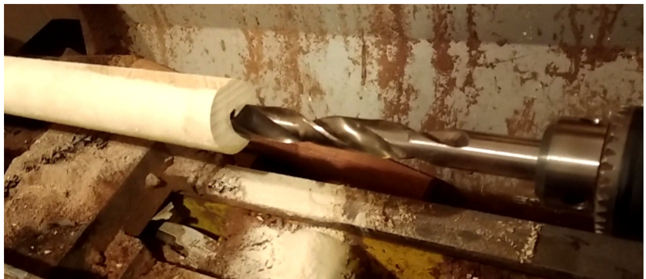
Ilustracja 6: Rozwiercanie już istniejącego otworu do większej średnicy.
