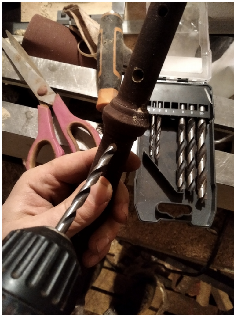
Ilustracja 22: Wiercenie otworów w przebierce, warto wykonać wiertłami do drewna.
