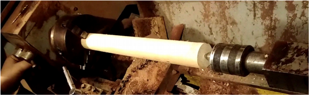
Ilustracja 4: Każdy element musi być przed wierceniem wycelowany za pomocą kła.
