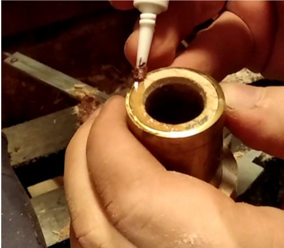
Ilustracja 8: Przyklejamy pierścień-dobrze jeśli pod pierścieniem jest nawinięta syntetyczna nić.
