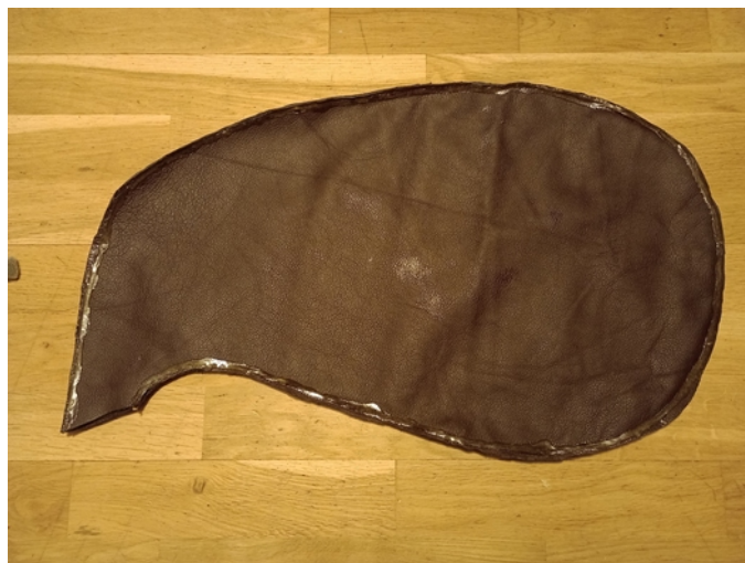
Ilustracja 20: Worek przed odwróceniem mizdrą na zewnątrz, widoczne zaklejone szwy,
