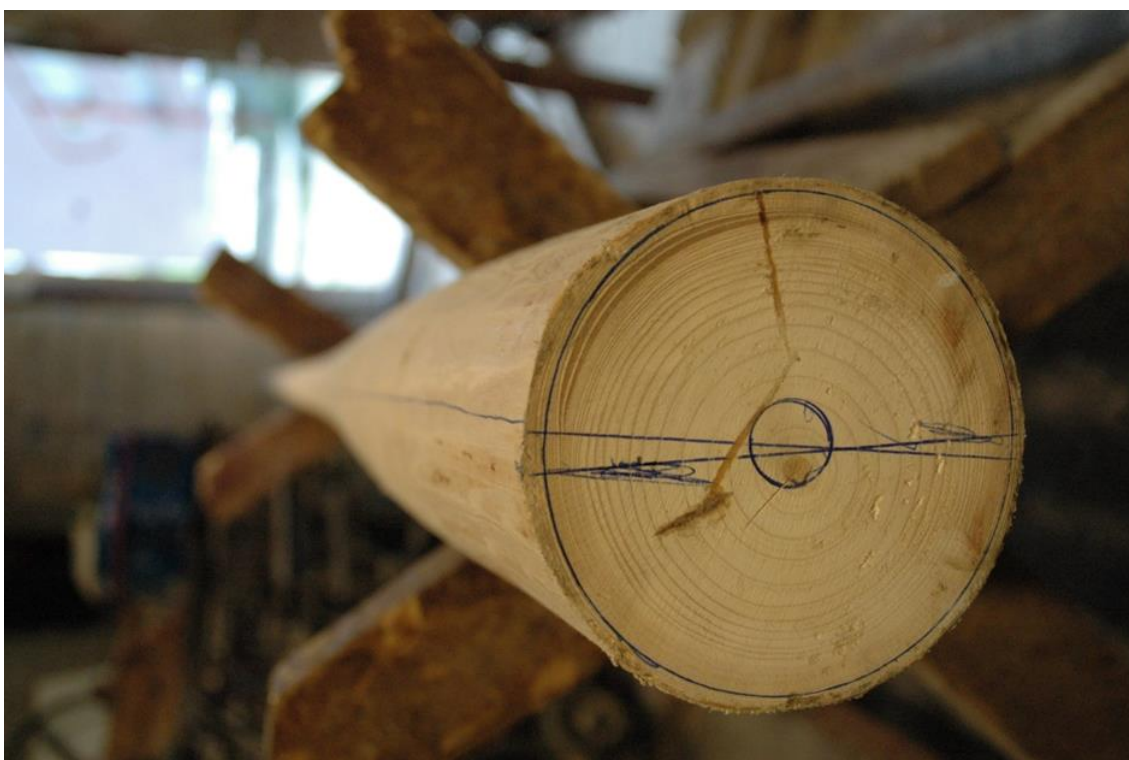
Wyznaczanie środka oraz grubości ścianek, fot. D. Kocemba
