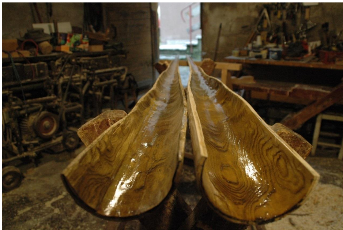
Wydrążone obie połówki, zabezpieczone i polakierowane, fot. D. Kocemba
