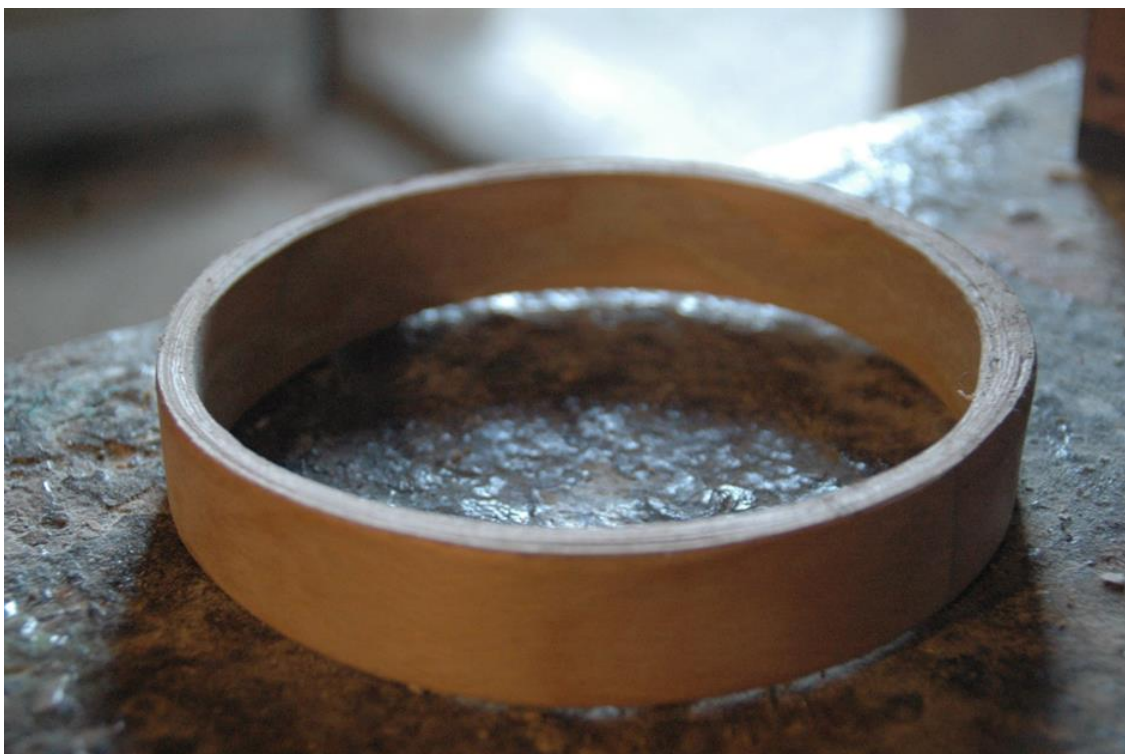
Obrączka z pasków z drewna bukowego, fot. D. Kocemba
