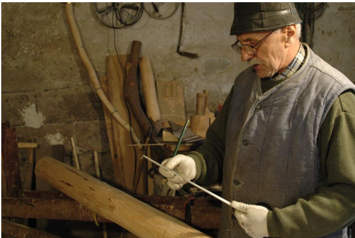
Wymierzanie długości oraz grubości przyszłego instrumentu, fot. D. Kocemba
