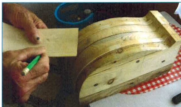
Fot. 10. Przyklejanie pasków wzmacniających od wewnętrznej strony każdego z fragmentów boków.
