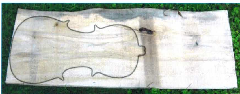
Fot. 3. Kształt dolnej płyty basów naniesiony na deskę lipową.
