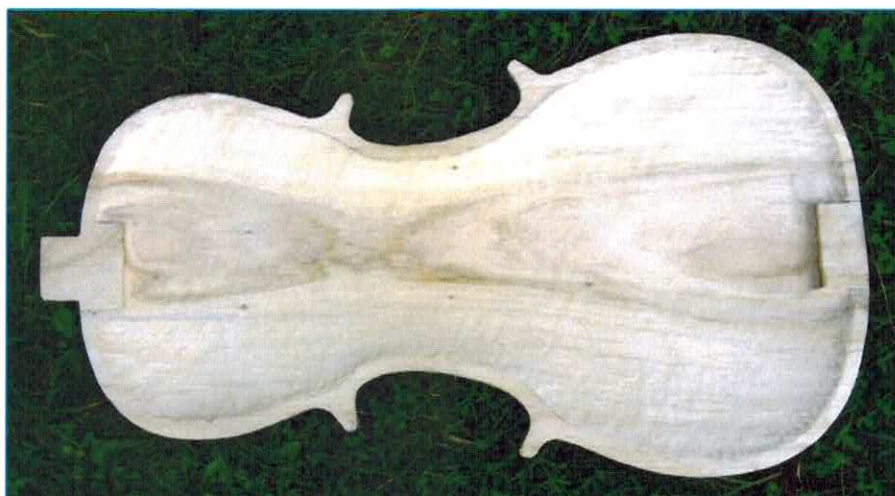
Fot. 4. Wydrążona od środka dolna płyta basów. Widać obwódkę o szerokości ok. 1 cm, do której przyklejone zostaną boki instrumentu.
