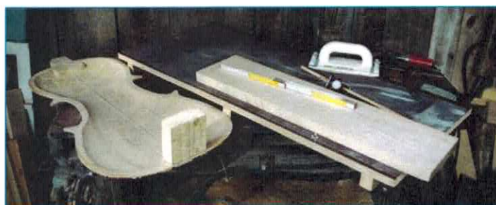
Fot. 11. Dolna płyta basów z wklejonym dolnym klockiem wzmacniającym. Obok deska oklejona papierem ściernym – po wklejeniu boków instrumentu deska użyta zostanie do równomiernego wyrównania krawędzi boków, które zetkną się później z górną płytą basów.
