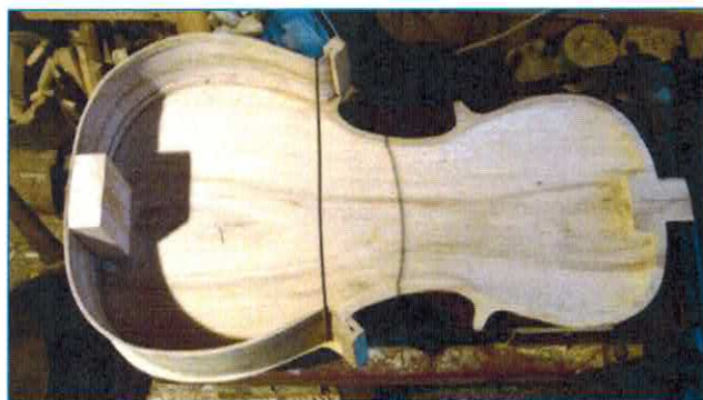
Fot. 12. Dolna część boków przyklejona do dolnego klocka wzmacniającego. Boki są ściągnięte drutem aby zapobiec ich odkształceniu. Górny klocek zostanie wklejony dopiero po połączeniu go z szyjką.
