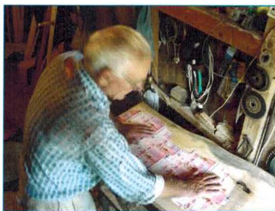
Fot. 2. Nanoszenie kształtu dolnej płyty basów na deskę lipową.
