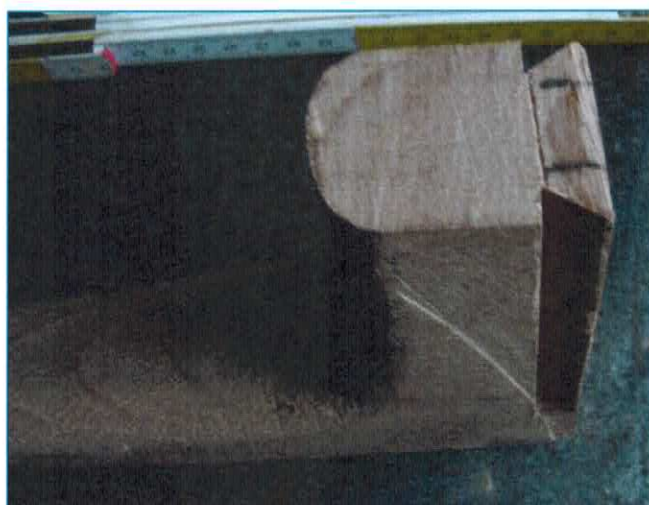
Fot. 17. Czop, który połączy szyjkę z górnym klockiem wzmacniającym.
