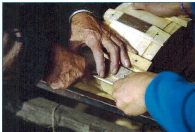
Fot. 9. Wyginanie boków instrumentu na specjalnej formie.
